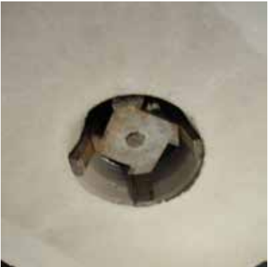
Tiegelhebergerät ohne Stahlbodenplatte von unten.
