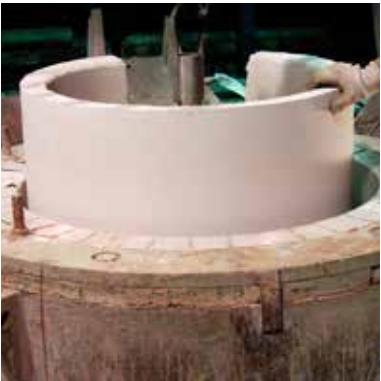
Der Dorit-Fertigtiegel wird mit Hilfe des Tiegelhebergeräts eingesetzt.
