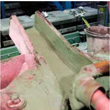
Die Gießschnauze wird den jeweiligen Gegebenheiten angepaßt.
